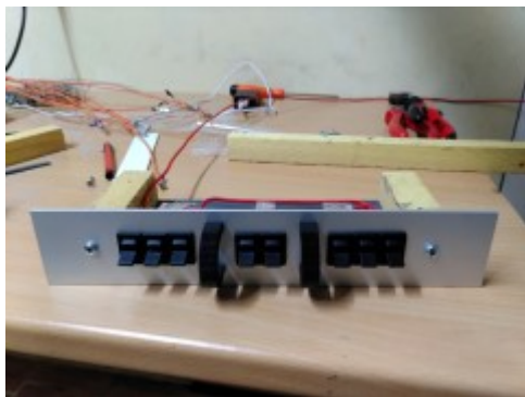
Assemblage de la façade
