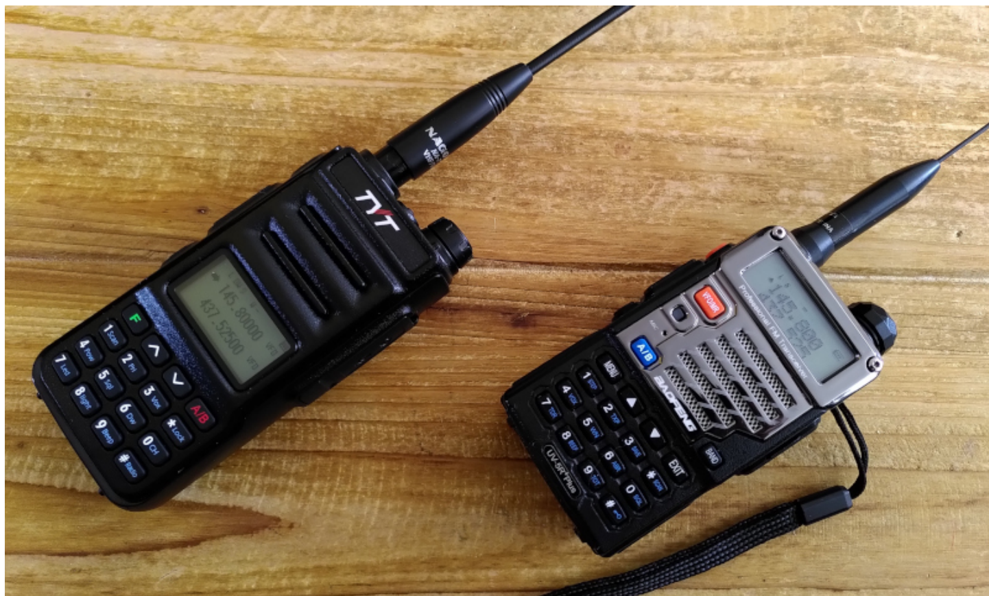
A gauche TYT TH-UV88 avec antenne Nagoya NA-771. A droite Baofeng UV5R avec antenne Nagoya NA-24.
